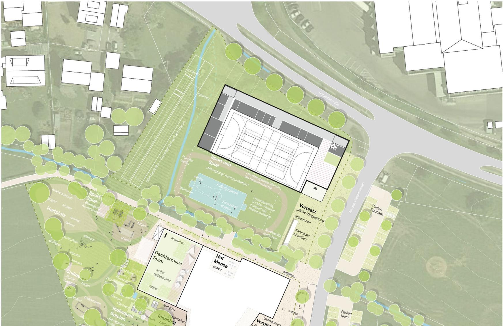
Möglicher Lageplan mit Erdgeschossgrundriss Sporthalle (Testentwurf)
