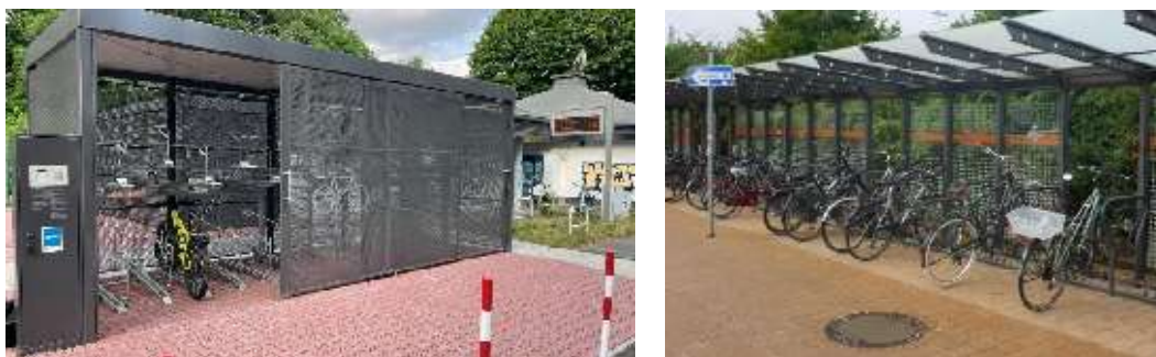
Abbildung 100: Beispiele für Fahrradabstellanlagen verschiedener Standards (Fahrradboxen abschließbar, überdachte Anlehnbügel)
