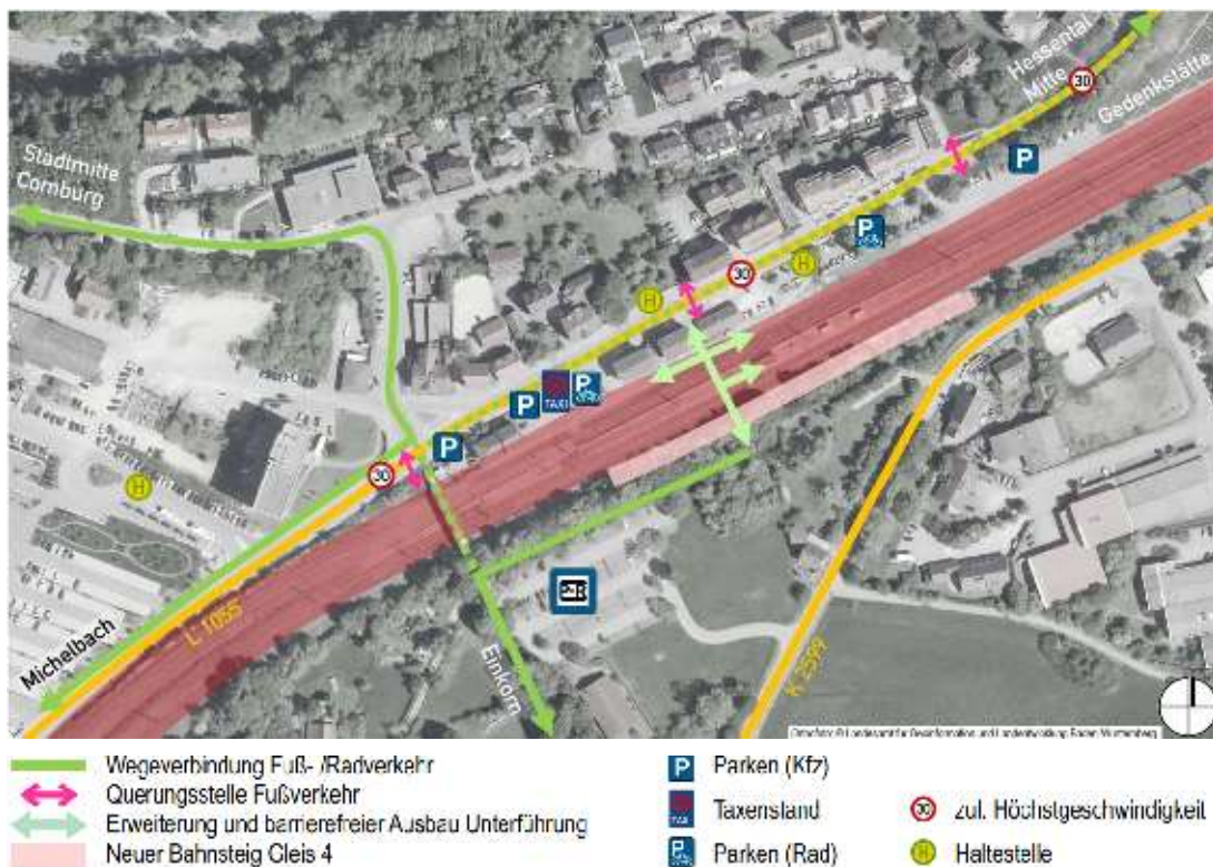
Abbildung 108: Neuorganisation der Verkehrsanlagen im Bahnhofsumfeld Hessental
