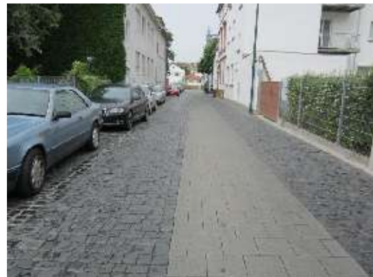
Abbildung 106: Beispiele für separate, barrierefreie „Laufbänder“ in einem verkehrsberuhigten Bereich bzw. Fußgängerzone
