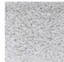
Beton mit gestockter natursteinähnlicher Oberfläche
