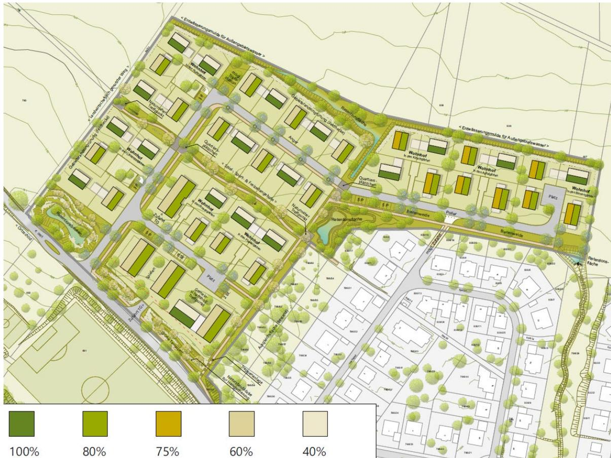
Abbildung 10: Maximal möglicher Ertrag von PV-Anlagen in Prozent für Dachflächen mit 45° Neigung
