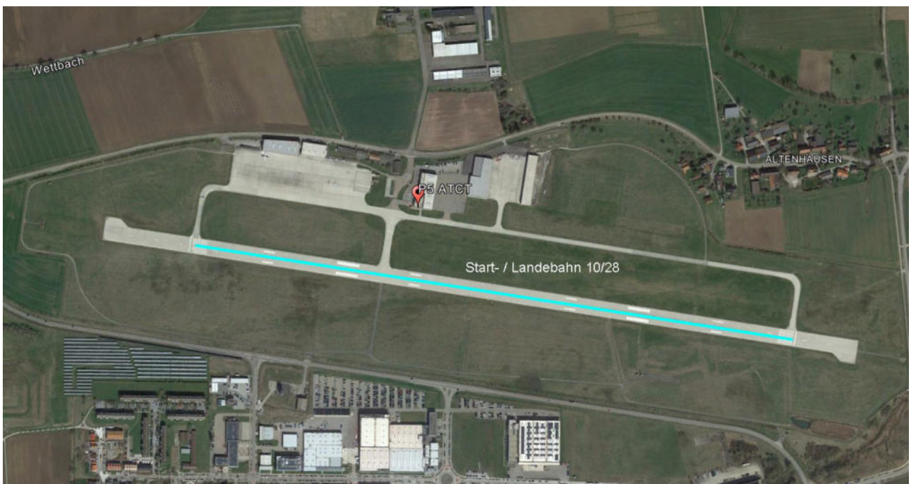
Bild 3.5.3: Start- / Landebahn Flugplatz Schwäbisch Hall , 1540 m Länge, 30 m Breite (Quelle: Google Earth/SolPEG)
