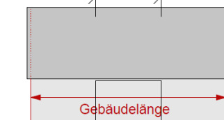
Vorbau mit Flachdach max. 1/3 der Gebäudelänge
