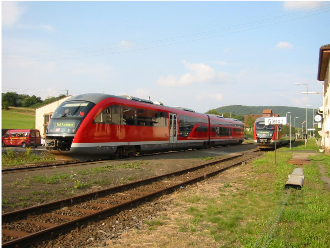
Abbildung 52: Beispiel für einen Dieselregionaltriebwagen – Siemens Desiro (Quelle: Wikipedia)
