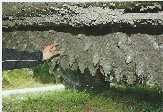
Die Fräsköpfe halten etwa 80 Kilometer Wegesanierung stand und sind schneckenförmig angeordnet.
