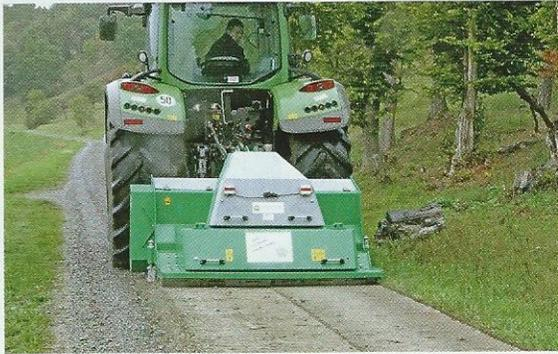
Bei der ersten Überfahrt wird der Schotter mit dem Untergrund vermischt. Die Fräse arbeitet bis zu 15 cm tief.
