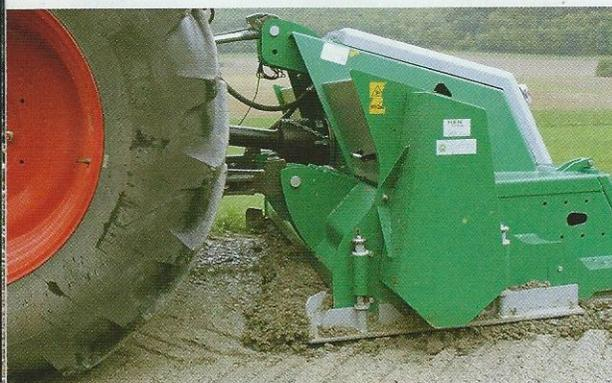
Beim Fräsen wird vor der Walze immer Schotter geschoben. So steht für Unebenheiten Füllmaterial bereit.
