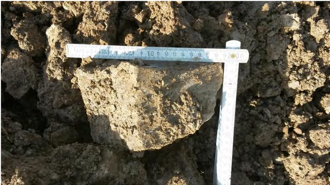
Foto Nr.68: Baggerschurf SCH13- grauer Mergelstein (Schicht 5.3)
