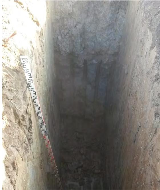
Foto Nr. 25: Baggerschurf SCH5 - Bodenprofil, oberer Bereich
