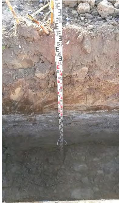
Foto Nr. 61: Baggerschurf SCH12 - Bodenprofil, oberer Bereich
