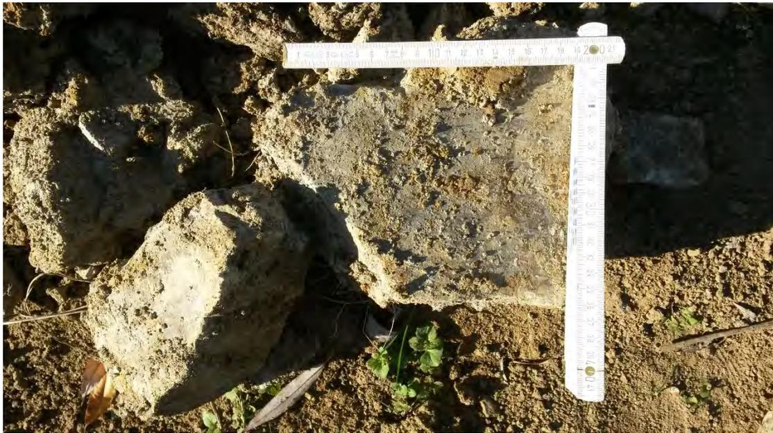
Foto Nr.62: Baggerschurf SCH12- Mergelstein (Schicht 5.3)
