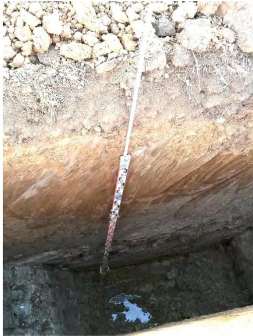
Foto Nr. 17: Baggerschurf SCH4 - Bodenprofil
