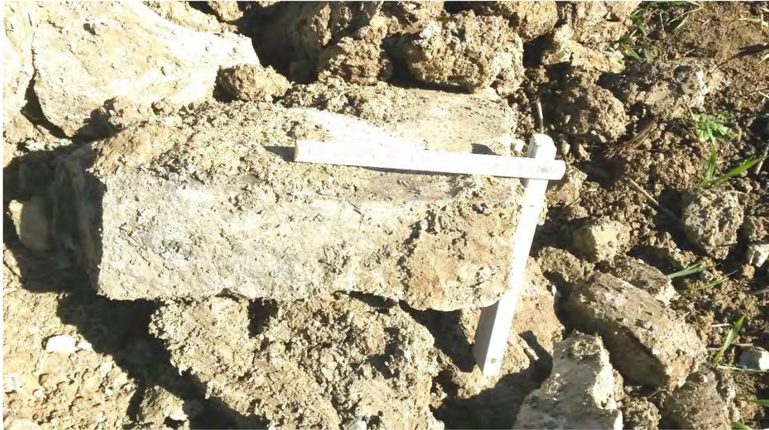
Foto Nr. 41: Baggerschurf SCH8- grauer Mergelstein (Schicht 5.3)
