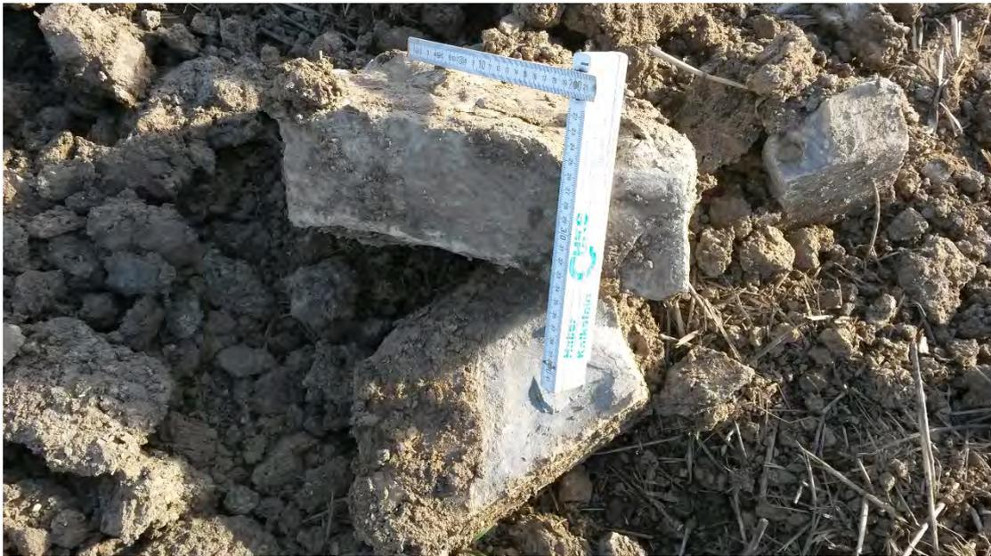
Foto Nr. 20: Baggerschurf SCH4- grauer Mergelstein (Schicht 5.3)
