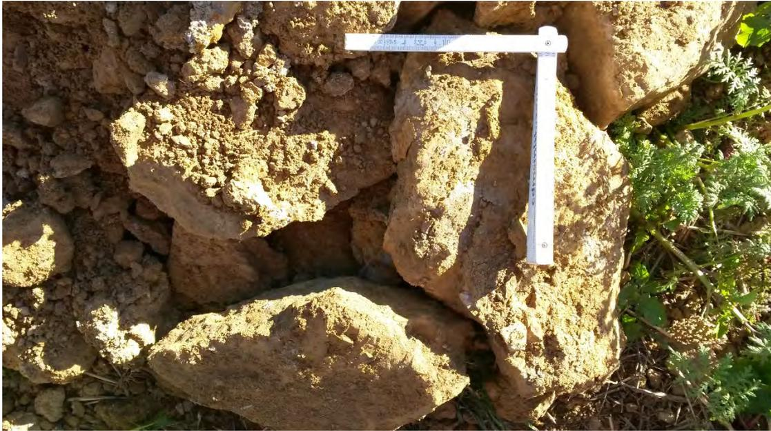
Foto Nr. 31: Baggerschurf SCH6- Mergelstein (Schicht 5.3)
