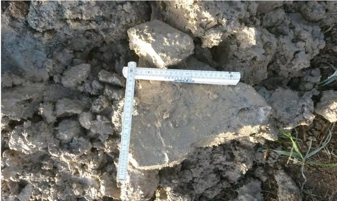
Foto Nr. 5: Baggerschurf SCH1-grauer Mergelstein (Schicht 5.3 )
