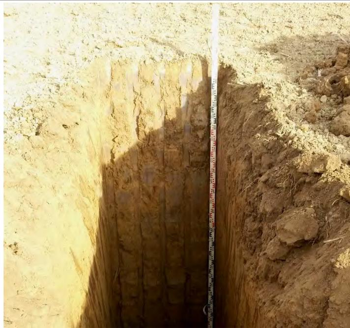
Foto Nr. 46: Baggerschurf SCH10 - Bodenprofil, oberer Bereich
