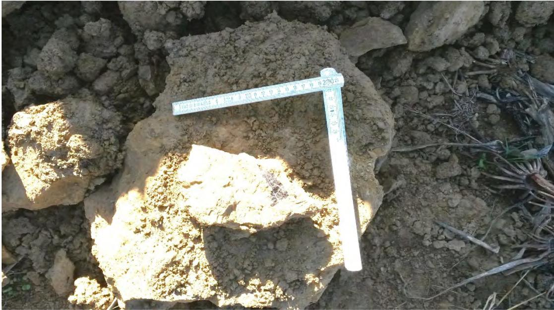
Foto Nr. 63: Baggerschurf SCH12-dolomitisierter Kalkstein (Schicht 6.3)
