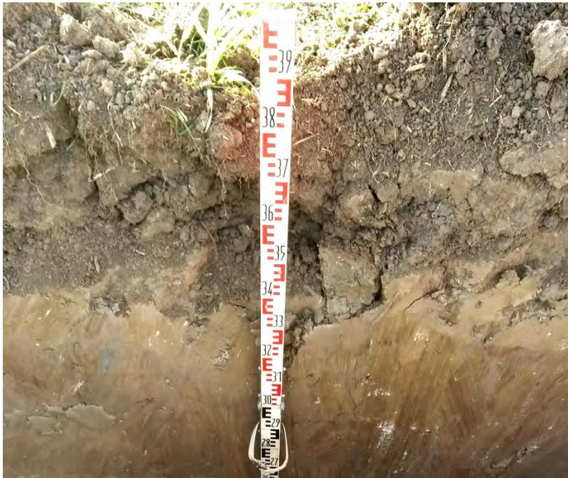
Foto Nr. 4: Baggerschurf SCH1 - Bodenprofil, oberer Bereich
