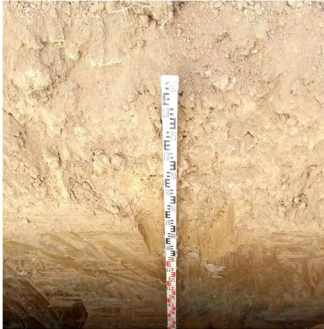
Foto Nr. 35: Baggerschurf SCH7 - Bodenprofil, oberer Bereich
