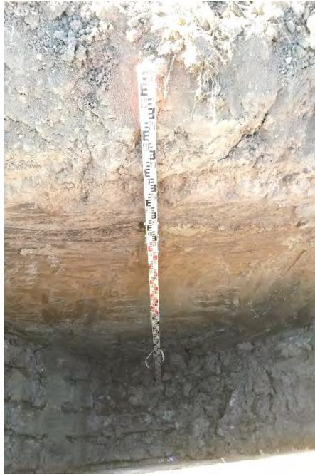
Foto Nr. 7: Baggerschurf SCH2 - Bodenprofil
