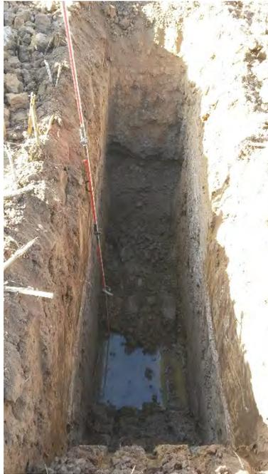
Foto Nr. 59: Baggerschurf SCH12 - Bodenprofil
