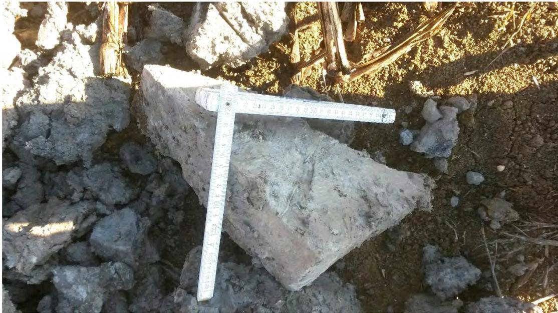
Foto Nr. 26: Baggerschurf SCH5- grauer Mergelstein (Schicht 5.3)
