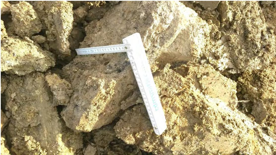
Foto Nr. 36: Baggerschurf SCH7- Mergelstein (Schicht 5.3)
