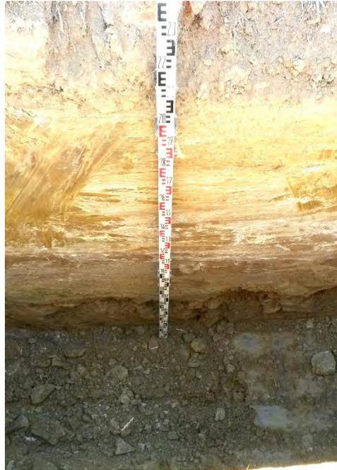
Foto Nr. 29: Baggerschurf SCH6 - Bodenprofil, unterer Bereich
