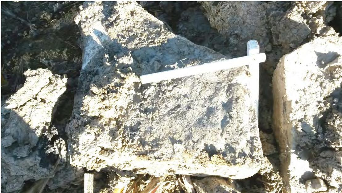
Foto Nr.10: Baggerschurf SCH2- grauer Mergelstein (Schicht 5.3)
