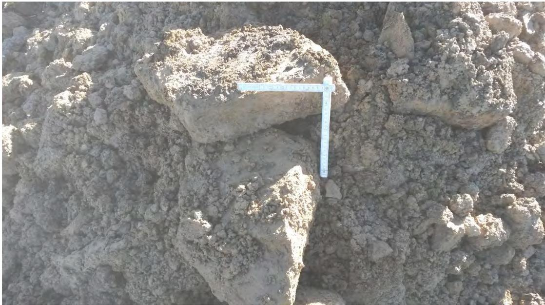
Foto Nr. 42: Baggerschurf SCH8-dolomitisierter Kalkstein (Schicht 6.3)
