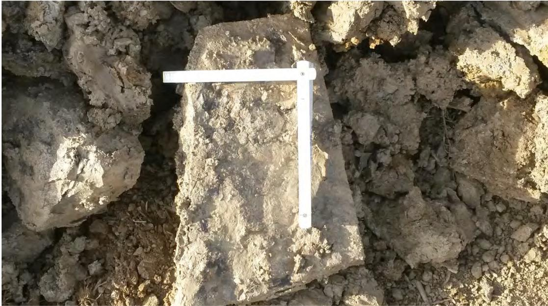
Foto Nr.47: Baggerschurf SCH10- grauer Mergelstein (Schicht 5.3)
