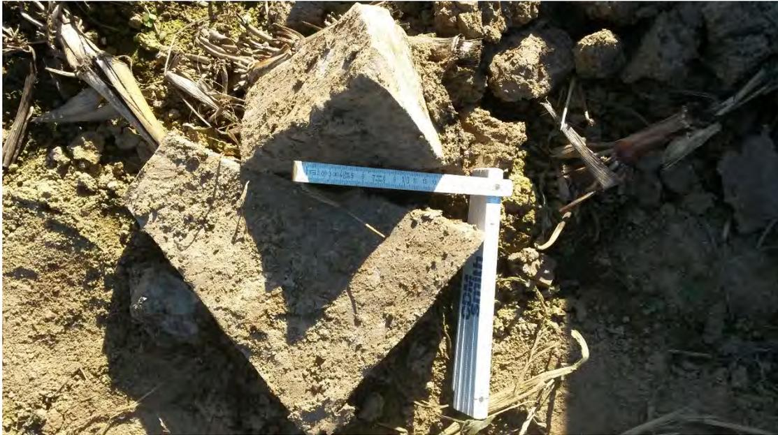
Foto Nr. 15: Baggerschurf SCH3- grauer Mergelstein (Schicht 5.3)
