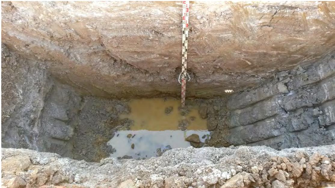
Foto Nr. 39: Baggerschurf SCH8 - Bodenprofil, unterer Bereich
