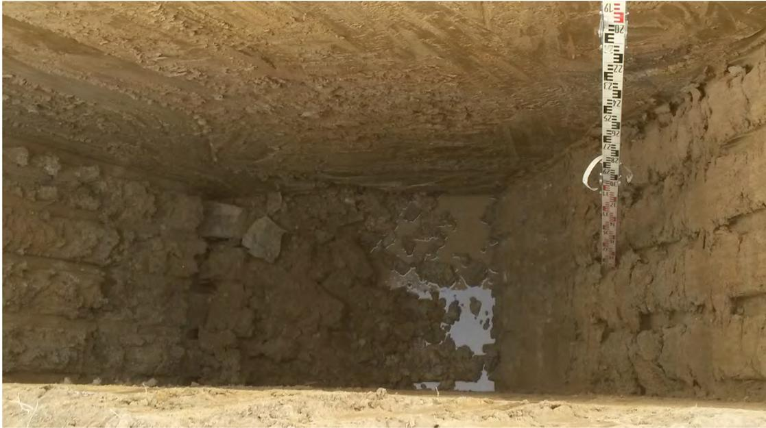
Foto Nr. 45: Baggerschurf SCH10 - Bodenprofil, unterer Bereich
