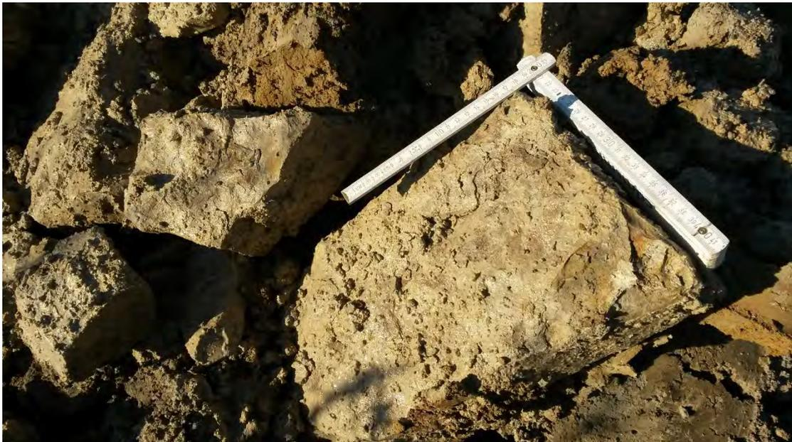
Foto Nr.52: Baggerschurf SCH11- Mergelstein (Schicht 5.3)
