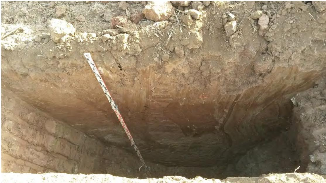
Foto Nr. 65: Baggerschurf SCH13 - Bodenprofil
