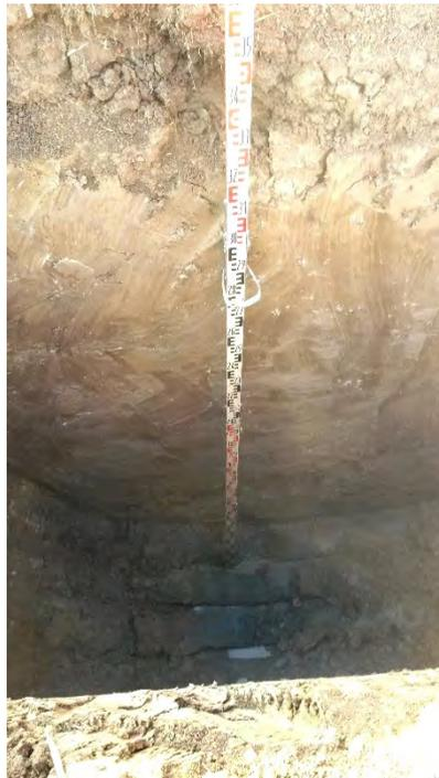
Foto Nr. 2: Baggerschurf SCH1 - Bodenprofil
