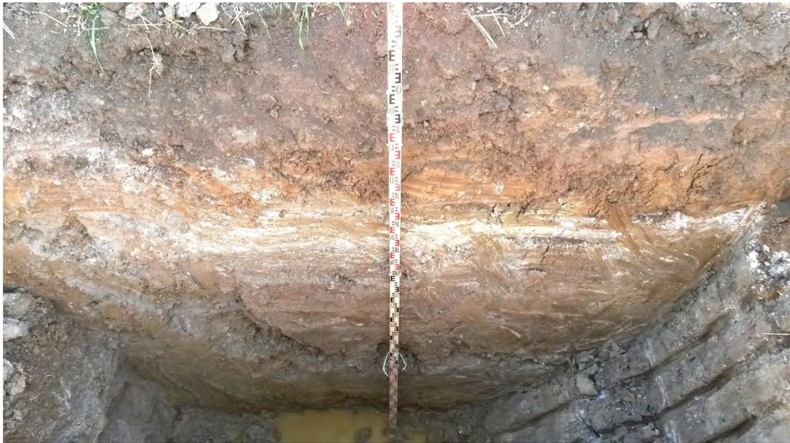
Foto Nr. 40: Baggerschurf SCH8 - Bodenprofil, oberer Bereich
